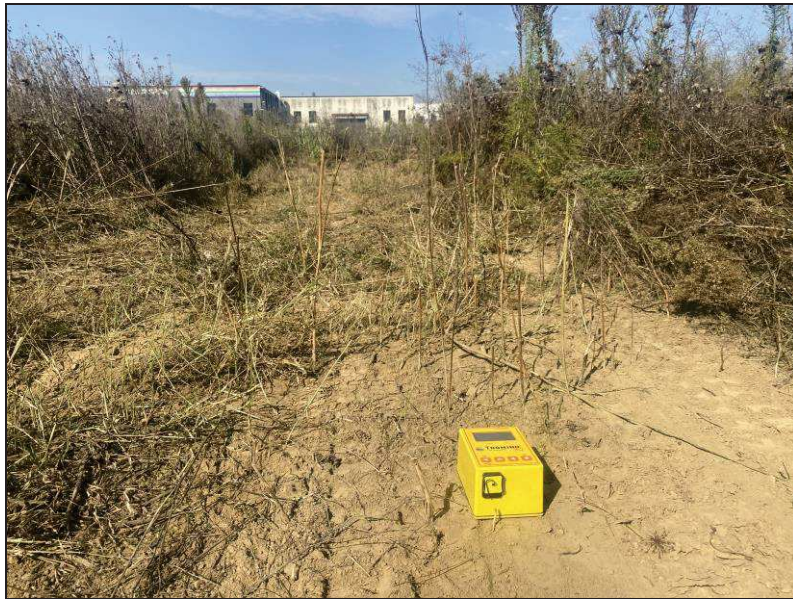
Figura 10: esecuzione di registrazione di sismica passiva n. 1 presso l'area oggetto di intervento.
