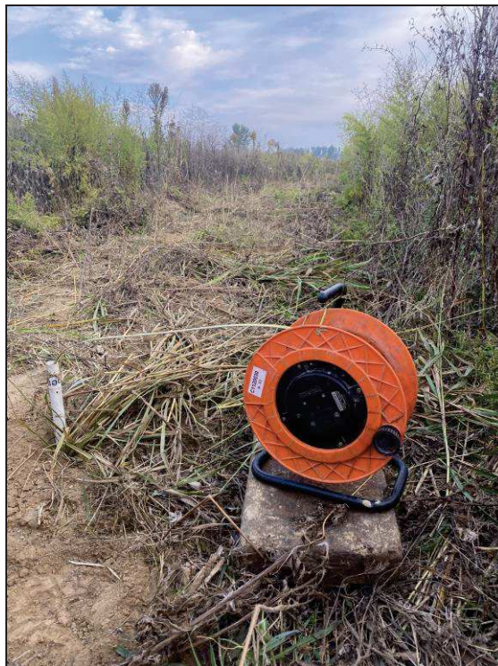
Figura 13: tubo piezometrico e rilevazione freatimetrica in corrispondenza della prova P1, comune di Vaiano Cremasco (CR), via Nelson Mandela (ATi1), il 28/09/2023
